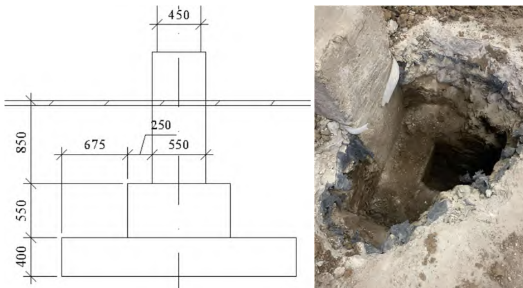
27 pav. Pastato Nr. 4 kolonos pamatas
