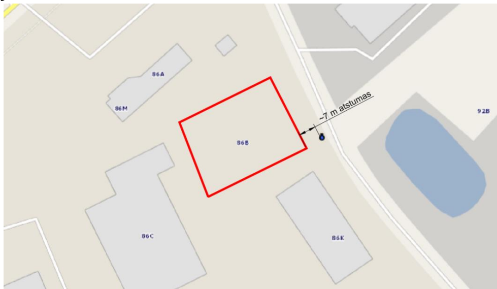
3 pav. Artimiausio gaisrinio hidranto schema
