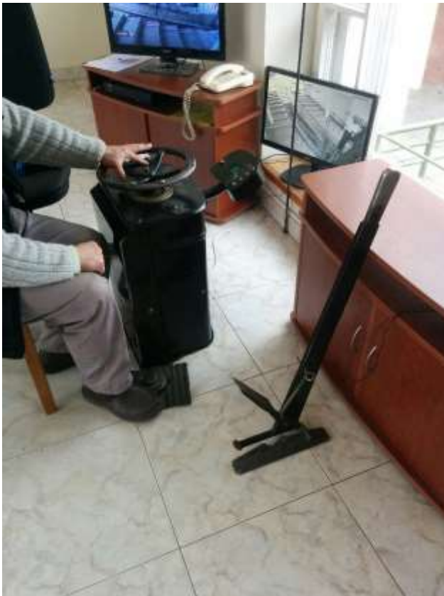
(F-7). Stotis. I a. valdymo patalpos įranga: varžų perjungimo pultas, šuntavimo pedalas, darbinio stabdžio svirtis..
